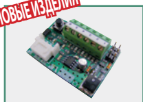
P111408 - SCS WIE Плата для прямого соединения аксессуаров WIEGAND (типа SELETTO, COMPAS SLIM, и т.д.) к модулям управления QSC D MA, LIBRA C MA, LIBRA C MV, LIBRA C LX, VENERE D, LEO D MA, LEO MV, RIGEL 5 и ALTAIR P.
