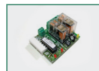
D111704 - SSR5 Плата управления для светофора и обогрева для панели управления RIGEL 5. Устройство способно функционировать при -20^{\circ}\text{C} этой деталью.
