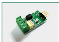
P111323 - SCS Последовательная панель управления для HYDRA R
