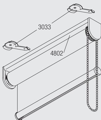
Комплектная система поставляется на предварительно собранном несущем профиле для быстрого монтажа. Защёлкнуть при помощи потолочного кронштейна 3033.
