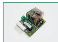
D111704 - SSR5 Плата управления для светофора и обогрева для панели управления RIGEL 5. Устройство способно функционировать при -20^{\circ}\text{C} этой деталью.
