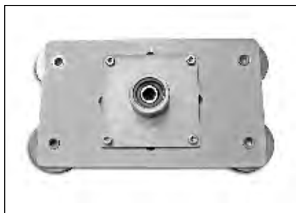
Рис.3.3 Установка суппорта SBB32.
